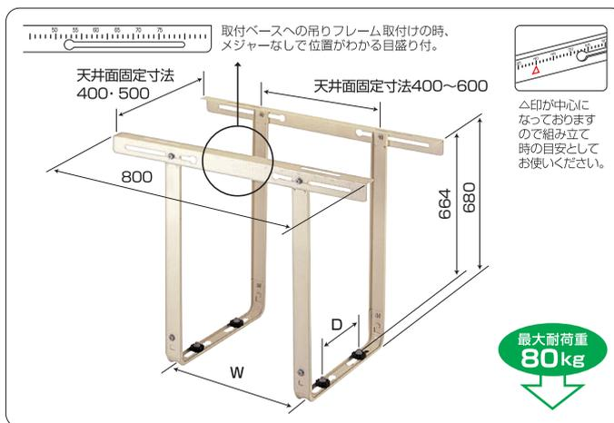
吊り下げ高さが2段階(600・700mm)に調節できる天吊り用。
