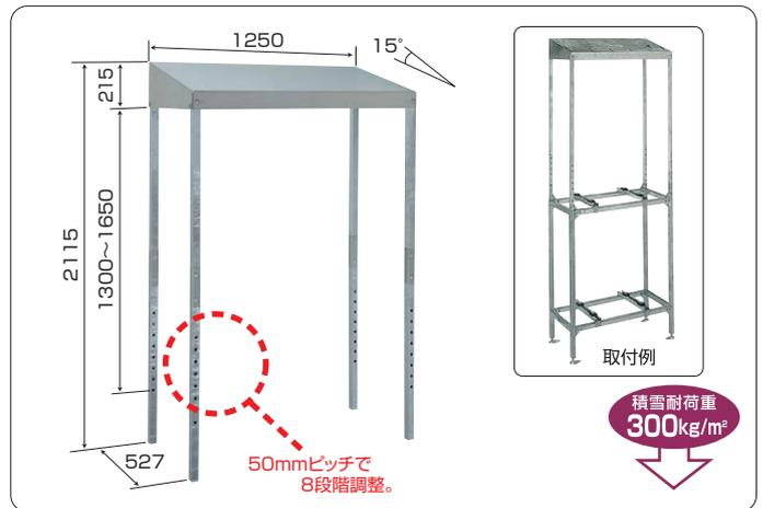
**パッケージエアコン用** 連結架台に取付けできる組立簡単な防雪屋根です。
