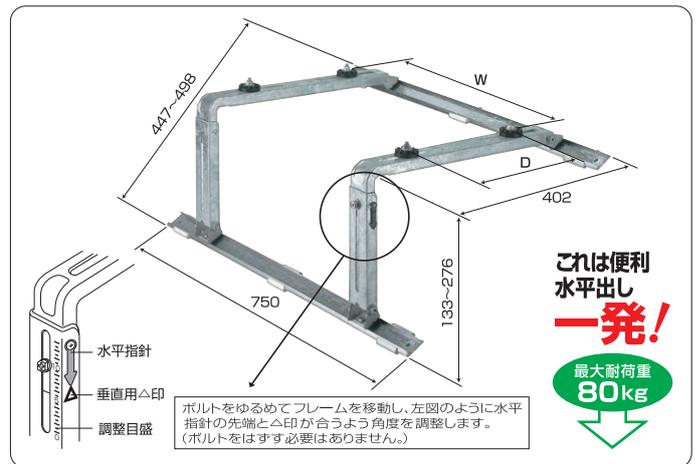
ボルトを外さずに簡単、確実に角度調整。オーソドックスな傾斜屋根据付架台。
