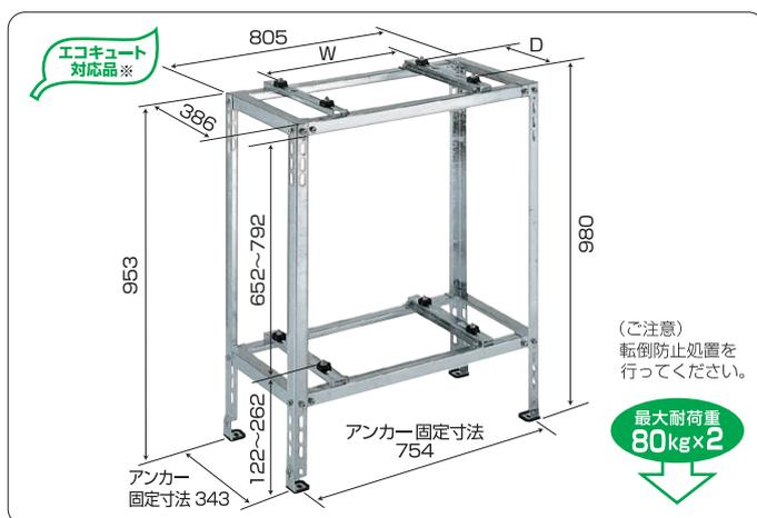
エコキュート用ヒートポンプユニットが設置できる平地二段置用。
