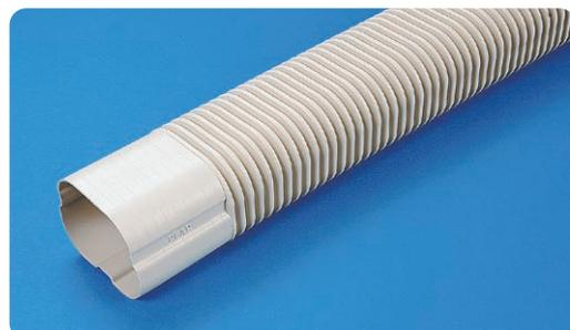
コーナーパーツでは対処できない曲げ施工用のパーツです。ダクトに直接差込んで使用してください。配管後の取り付けはできません。
