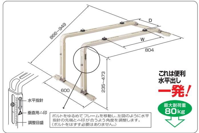
B-YT2のメッキタイプ。水平器なしでも確実に水平出しができ組立て簡単。
