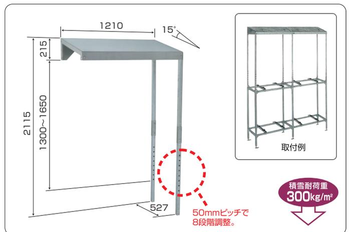
**パッケージエアコン用** 壁面用架台、平地置用架台のどちらでも使用できる
