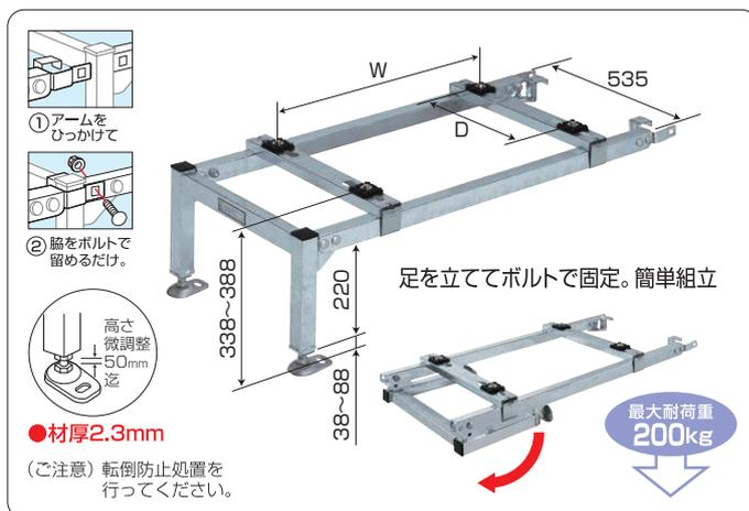
**パッケージエアコン** 専用組立工具不要で簡単組立の平地置(H=500)タイプ。
