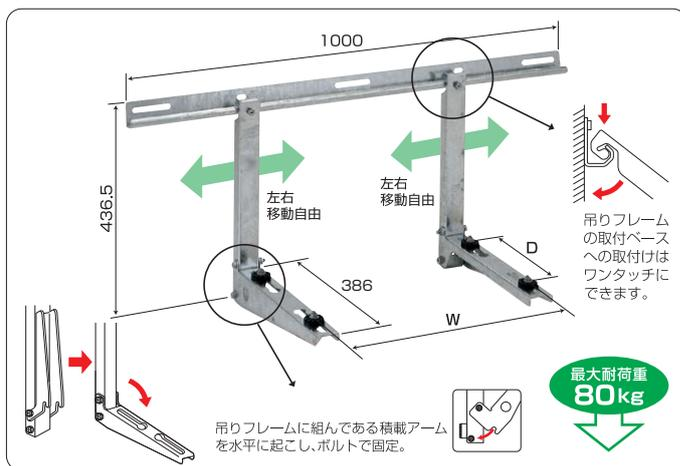
B-KMより横幅が300mm短い。(ツーバイフォー住宅用・コンクリート壁用)
