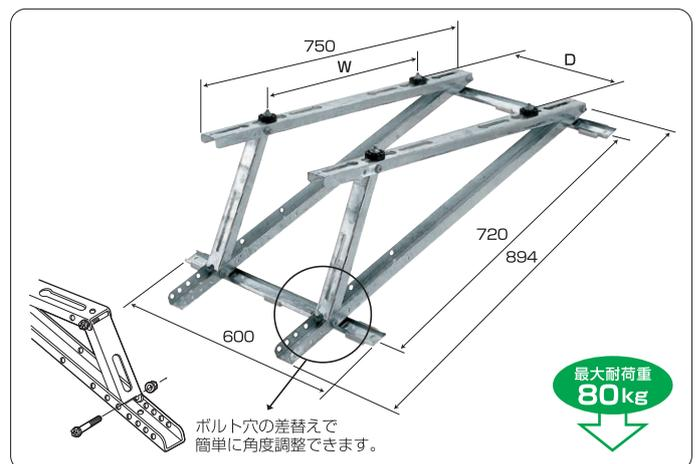
B-YAT3のメッキタイプ。水平器なしでも確実に水平出しができ組立て簡単。
