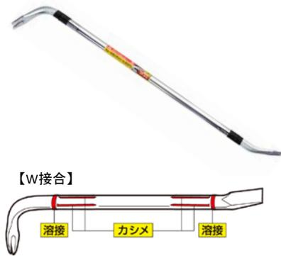
・溶接とカシメによるW接合で、中間部が空洞になっているにもかかわらず、強度・耐荷重に優れています。
