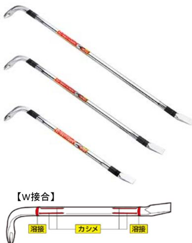
・溶接とカシメによるW接合で、中間部が空洞になっているにもかかわらず、強度・耐荷重に優れています。
